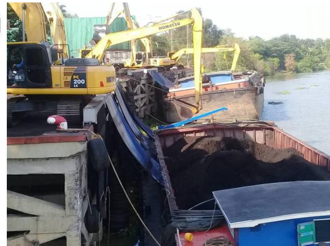
ระบบป้องกันถ่านหินล้นหล่น (ควบคุมปริมาณการตัก)
