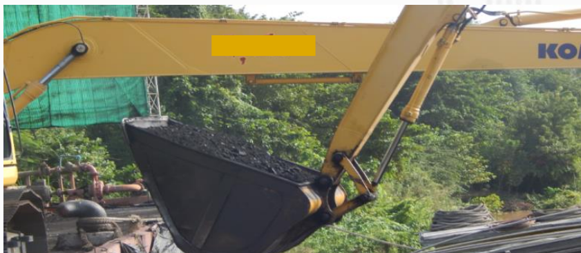
ระบบป้องกันถ่านหินร่วงหล่น (ควบคุมปริมาณการตัก)
