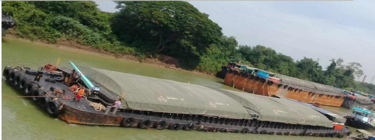
ตรวจเช็คการคลุมผ้าใบเรือบรรทุกถ่านหินก่อนเทียบท่า
