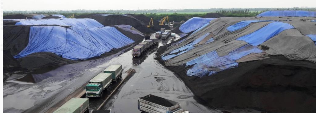
การใช้ผ้าใบคลุมกองถ่านหิน ที่อยู่ภายนอกอาคาร
